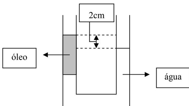
Assinale a alternativa que contém o volume de óleo ( $\rho_o = 900 \text{ kg/m}^3$ ), em centímetros cúbicos, que deve ser colocado em um dos ramos do tubo para causar uma diferença de 2 cm entre as superfícies superiores do óleo e da água, conforme mostra a figura.
