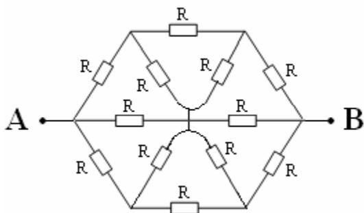
A resistência equivalente entre os pontos A e B é:
