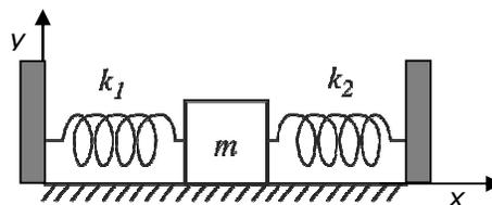
Dada uma velocidade inicial ao bloco, na direção do eixo- $x$ , este vibrará com frequência angular igual a
