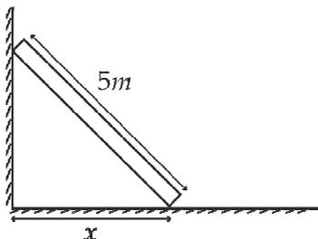
Considerando que a escada se comporta como uma barra homogênea de 5 m e peso 100 N, e sabendo que o coeficiente de atrito estático entre a escada e o chão é 0,5, a distância máxima  $x$  que a base da escada pode estar da parede, sem deslizar, é, aproximadamente, igual a
